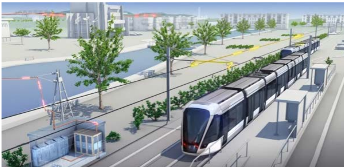
Figura 34 - Ilustração do funcionamento do reversível instalado
