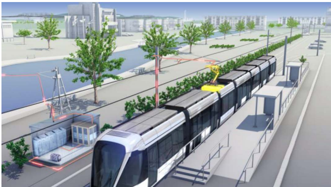
Figura 37 – Fluxo energético dos trens para a rede elétrica
